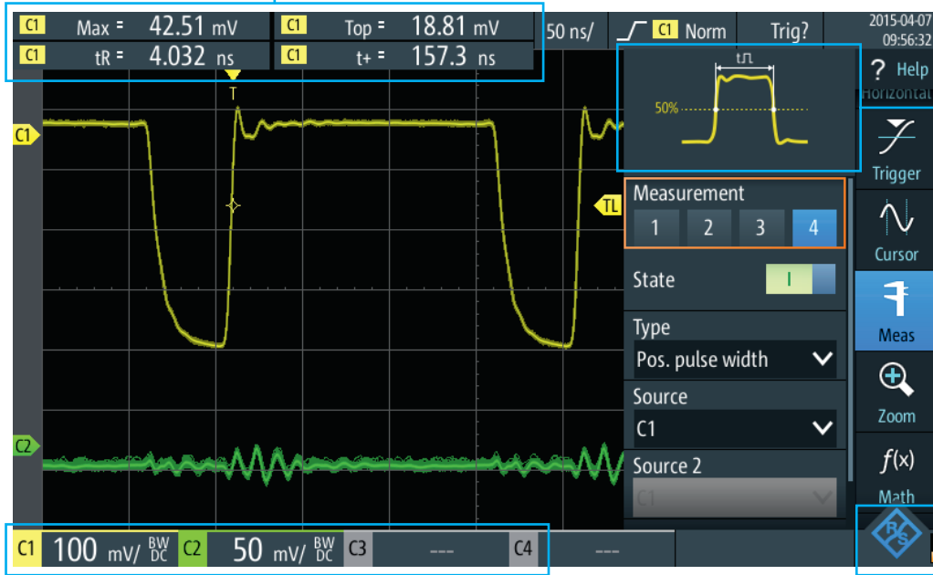
Los indicadores de canal codificados por colores muestran los ajustes principales de cada canal de entrada.
