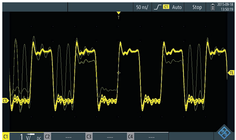
Fig. 1: Gracias a la elevada frecuencia de adquisición del R&S®ScopeRider, los errores en esta señal de reloj se hacen visibles. La representación según el grado de luminosidad permite identificar que se trata de señales de error esporádicas.
