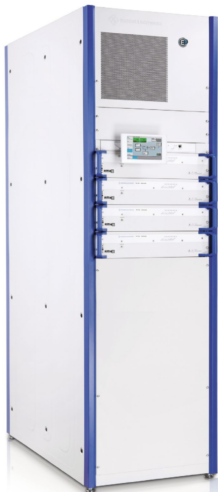
Fig. 1: Transmisor de alta potencia VHF refrigerado por líquido R&S®THV9 con 5,2 kW de potencia de salida con cuatro amplificadores.
