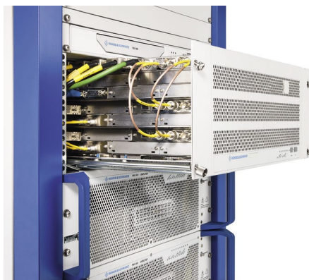
Fig. 2 Le R&S®TMU9 est hautement configurable : ici, les appareils de base R&S®TCE900 sortis de leur baie sont capables, à l'aide de cartes enfichables, de fonctionner comme émetteur pilote ou commande d'émetteur.
