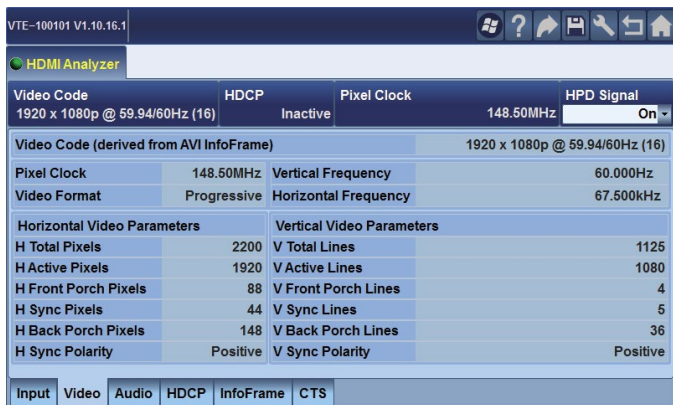
Fig. 3 Las nuevas opciones de análisis incluyen también un análisis completo de protocolo de las señales HDMI.
