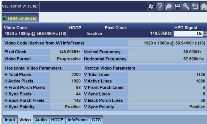
BILD 3 Mit den neuen Analyseoptionen ist unter anderem eine umfassende Protokollanalyse von HDMI-Signalen möglich.
