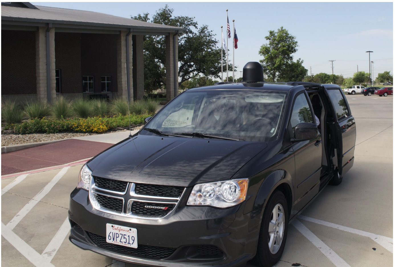
BILD 4 Peilfahrzeug mit Peilantenne R&S®ADD107 (20 MHz bis 1,3 GHz) und Peiler R&S®DDF007 (im Fahrzeug, nicht sichtbar).
