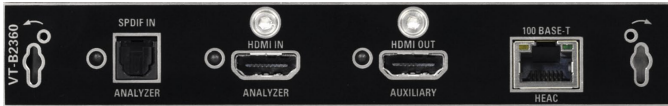
Fig. 2 Les options R&S®VT-B2360/2361 HDMI RX permettent de réaliser des tests sur des sources HDMI.
