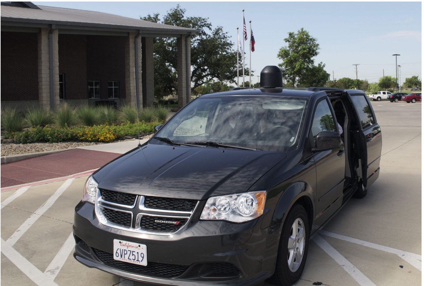
Fig. 4 Véhicule goniométrique équipé de l'antenne goniométrique R&S®ADD107 (20 MHz à 1,3 GHz) et radiogoniomètre R&S®DDF007 (dans le véhicule, non visible).
