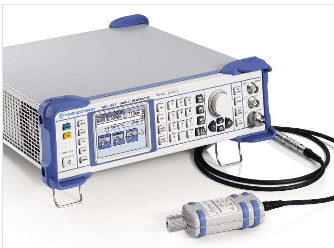
FIG. 1 R&S®SMB100A con sensor de potencia R&S®NRP-Z85 conectado (a través de cable adaptador USB R&S®NRP-Z4) para la medición directa de nivel con indicación en el display del generador.
