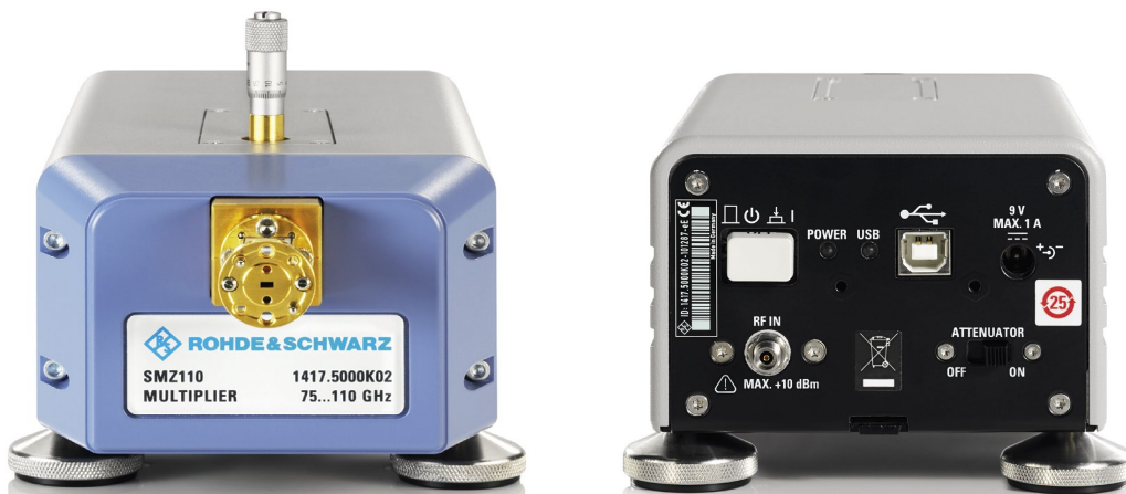
Fig. 1 Vue avant et arrière du multiplicateur de fréquence R&S®SMZ110, à gauche avec atténuateur mécanique, à droite avec atténuateur électronique.
