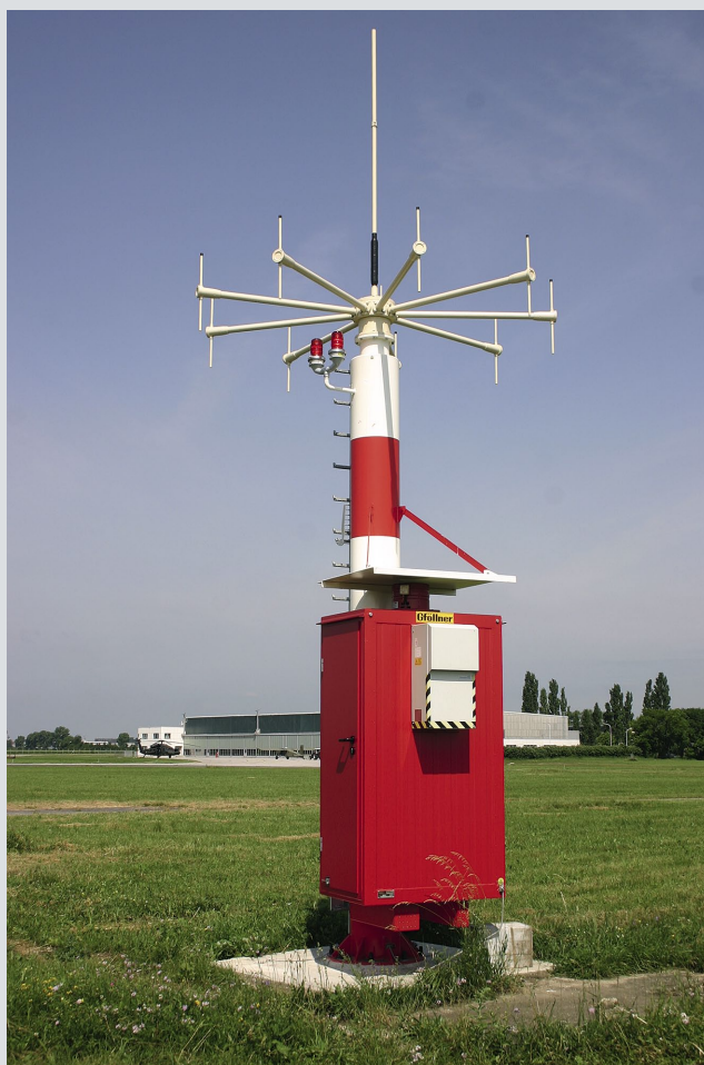
BILD 2 Der Peiler R&S®DDF04E auf dem Fliegerhorst Brumowski. Ein isolierter vollklimatisierter Outdoor-Schrank am Mastfuß nimmt den Peilgerätesatz und den Peilserver auf.
