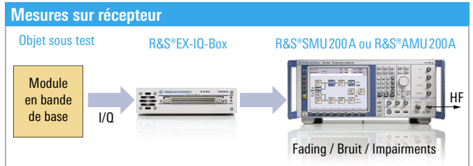
Fig. 3 Le générateur simule l'étage RF d'un émetteur de sorte que la section en bande de base peut être testée indépendamment de la section RF.
