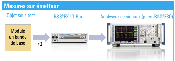
Fig. 4 Les nombreuses possibilités d'analyse sur signaux en bande de base numériques des principales normes sont disponibles, par exemple pour les mesures sur modules d'émetteurs en bande de base.
