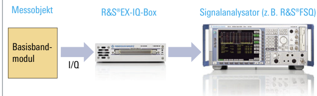
BILD 4 Die vielfältigen Möglichkeiten der Analytoren, digitale Basisbandsignale aller wichtigen Standards zu analysieren, stehen zur Verfügung, z. B. für Sendermessungen an Basisbandmodulen.
