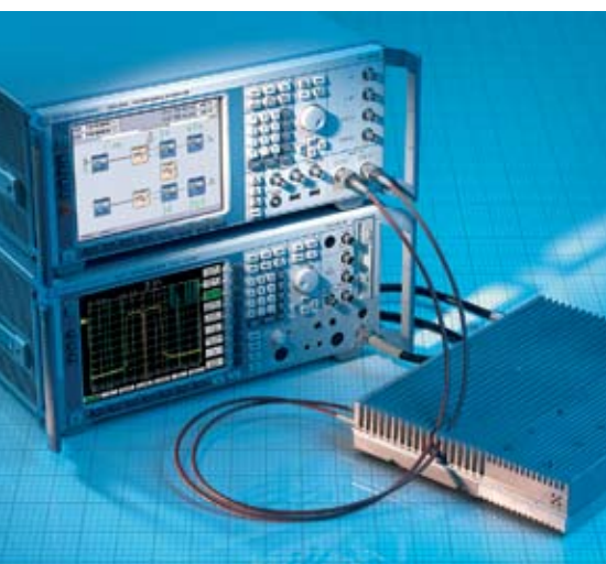
Рис. 4. Векторный генератор сигналов R&S®SMU200A (сверху) и высококачественный анализатор сигналов R&S®FSQ в схеме для измерения усилителей мощности.
