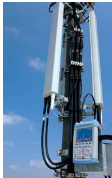
Рис. 8. R&S®FSH3 – универсальный измерительный прибор, необходимый во время установки и обслуживания, используется для измерения параметров антенн базовых станций.
