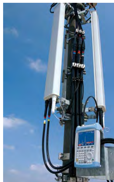
Fig. 8 Le R&S®FSH3, un appareil de mesure complet pour l'installation et la maintenance sur site, au cours de mesures sur une antenne radio mobile.
