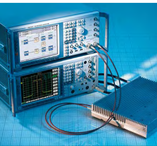
Fig. 4 Le générateur de signaux R&S®SMU 200 A (appareil du haut) et l'analyseur de signaux R&S®FSQ lors d'une mesure sur un amplificateur de puissance.
