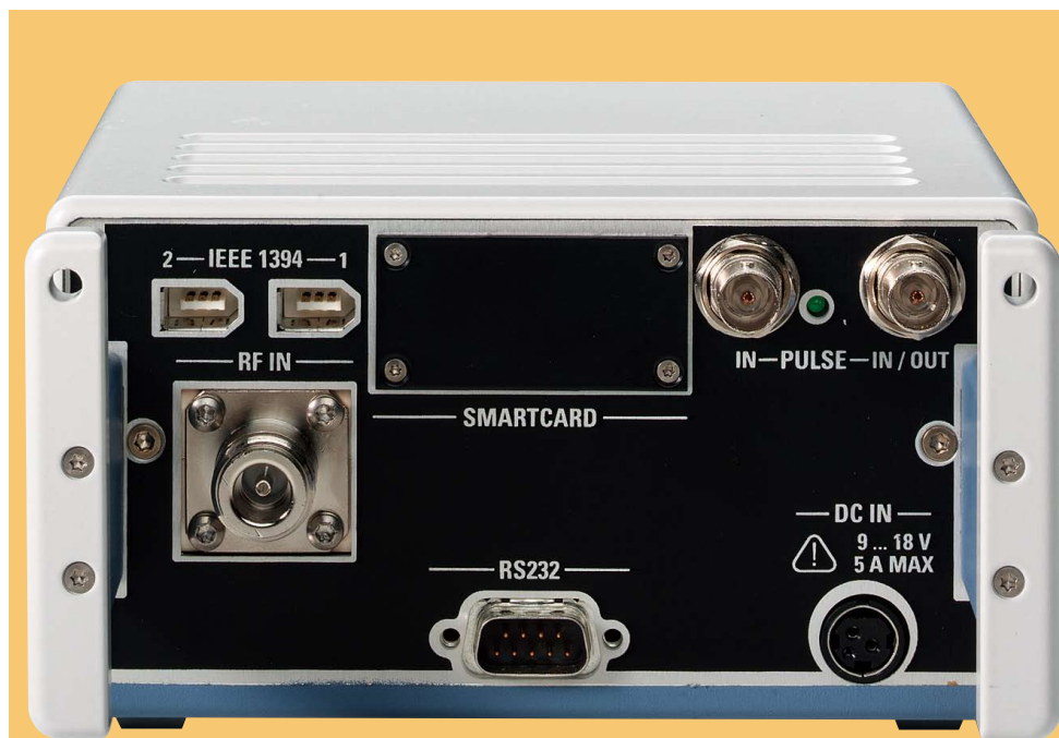
Рис. 2. Анализатор R&S®TSMU, вид сзади. В правом верхнем углу расположены вход синхронизации и импульсный вход, слева – гнездо для антенны и два разъема FireWire для каскадного соединения анализаторов R&S®TSMU на один контроллер. Интерфейс RS-232 обеспечивает обмен служебной информацией.
