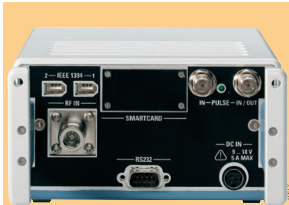
Fig. 2 Vue arrière du R&S®TSMU avec l'entrée de synchronisation et l'entrée capteur de roue en haut à droite, la prise antenne et deux raccords FireWire pour la mise en cascade d'un maximum de 62 R&S®TSMU sur un PC. L'interface RS-232-C fournit des informations de service.
