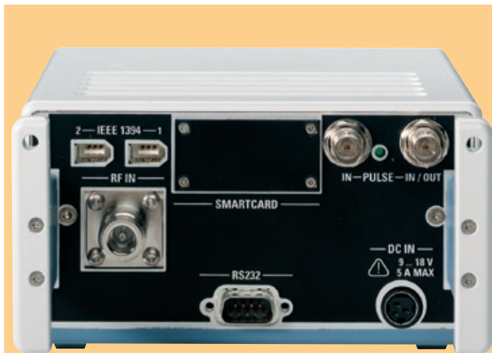
BILD 2 Rückansicht des R&S®TSMU mit Synchronisations- und Wegpulseneingang oben rechts, Antennenbuchse und zwei Firewire-Anschlüssen zur Kaskadierung von bis zu 62 R&S®TSMU an einem Steuerrechner. Die RS-232-C-Schnittstelle liefert Service-Informationen.
