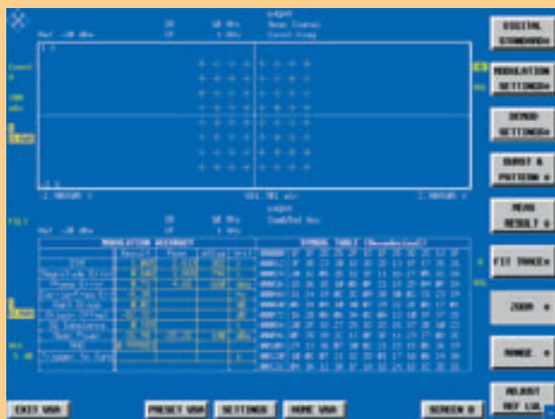
Fig. 2 Diagramme de constellation, affichage numérique des résultats et symboles décodés d'un signal de mesure 64QAM.
