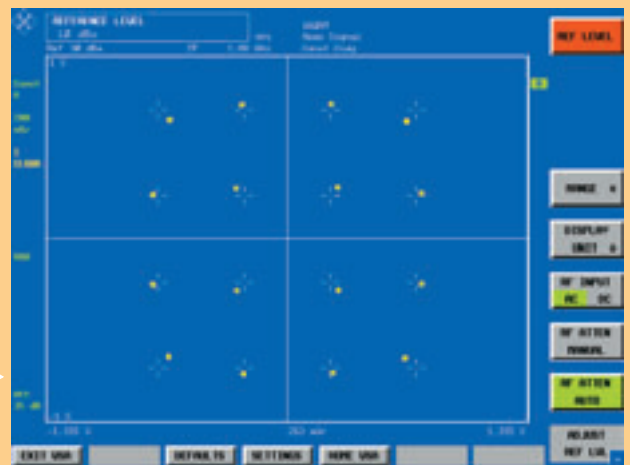
Fig. 12 Courbes de distor- sion, conversion AM/ AM ou AM/ \phi M. Bleu: points de mesure indi- viduels; jaune: courbe de conversion interpolée.
