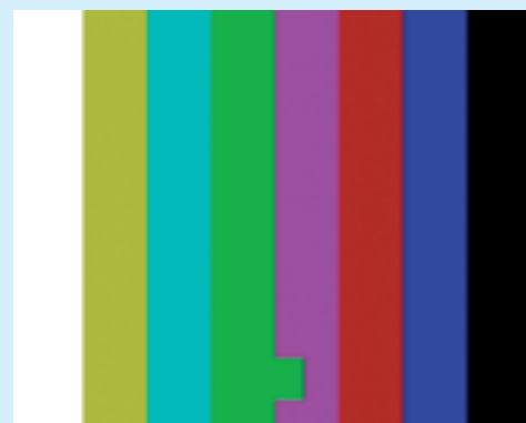
Barres de couleurs UIT-R BT.801-1 avec élément animé pour évaluation automatique de l'image dans le cadre de mesures d'immunité.
