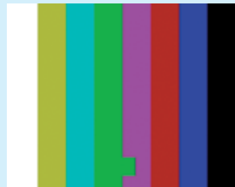
Farbbalken ITU-R BT.801-1 mit Bewegungselement zur automatischen Bildbewertung im Rahmen von Störfestigkeitsmessungen.
