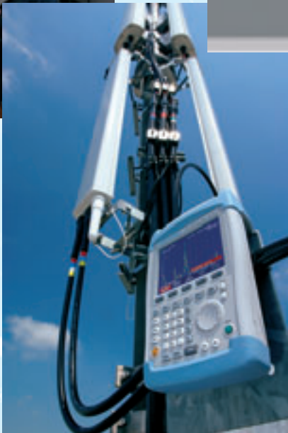
BILD 6 Der R&S FSH3, ein Komplettmessgerät für die Installation und die Wartung vor Ort. Links oben: Messung mit dem Leistungsmesskopf FSH-Z1, links unten: Messungen an Mobilfunk-einrichtungen.
