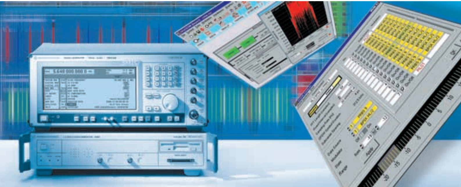
BILD 1 Mit dem Signalgenerator SMIQ (oben im Bild) und dem I/Q-Modulationsgenerator AMIQ lassen sich problemlos auch lange HiperLAN/2-Testsequenzen erzeugen.
