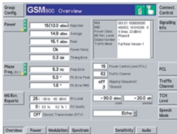
Fig. 4 Le menu « GSM Overview » indique tous les paramètres et réglages importants en GSM. Des « hotkeys » (en bas) permettent d'accéder rapidement à des menus spéciaux.
