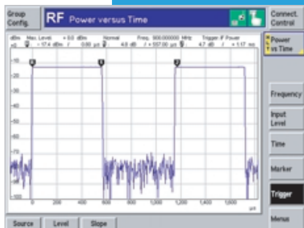
Fig. 6 Analyse conviviale de signaux TDMA/AMRT en mode « Zero Span ».
