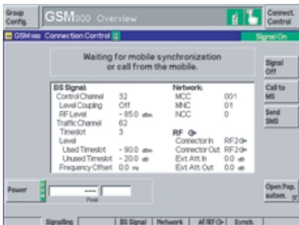
BILD 3 Mit Pop-up-Menüs führt der CMU200 zielgerichtet durch die Prozeduren des Verbindungsauf- und -abbaus.
