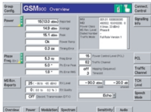
BILD 4 Das Menü GSM Overview zeigt alle bei GSM wichtigen Messwerte und Einstellparameter. Hotkeys (unten) ermöglichen den schnellen Wechsel in spezielle Menüs.
