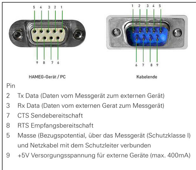
Abb. 1.2: Pinbelegung der RS-232 Schnittstelle
