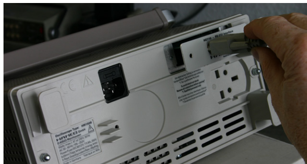
Abb. 2.2: Ausbau der Schnittstellenkarte
