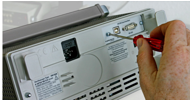
Abb. 2.1: Lösen der Befestigungsschrauben
