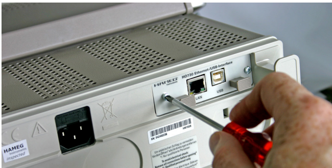
Abb. 2.4: Festschrauben der Schnittstellenkarte
