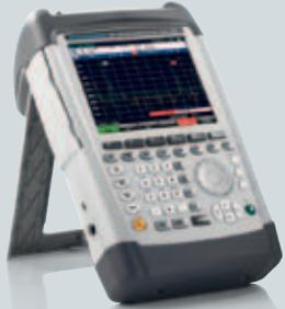
Das Grundgerät ist in zwei Modellen (bis 3,6 GHz bzw. 8 GHz) erhältlich und beherrscht alle Messungen, die bei der Installation und Wartung von Antennenanlagen benötigt werden: Dämpfungs- und Anpassungsmessungen sowie die Kabelfehlstellenortung.
