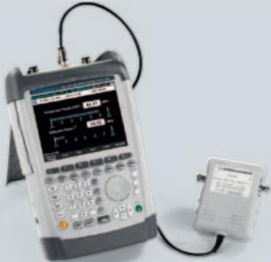
Weitere Funktionen lassen sich per Software-Freischaltung oder Zusatzausstattung nachrüsten, ohne dass das Gerät zum Service muss: Spektrumanalyse, Netzwerkanalyse, Leistungsmessung, Vektor-Voltmeter, GPS-Empfang, Fernsteuerung.
