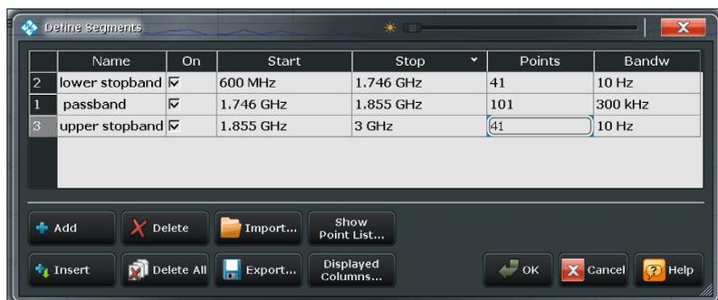
Segmentierter Sweep zur Messung eines Filters.
