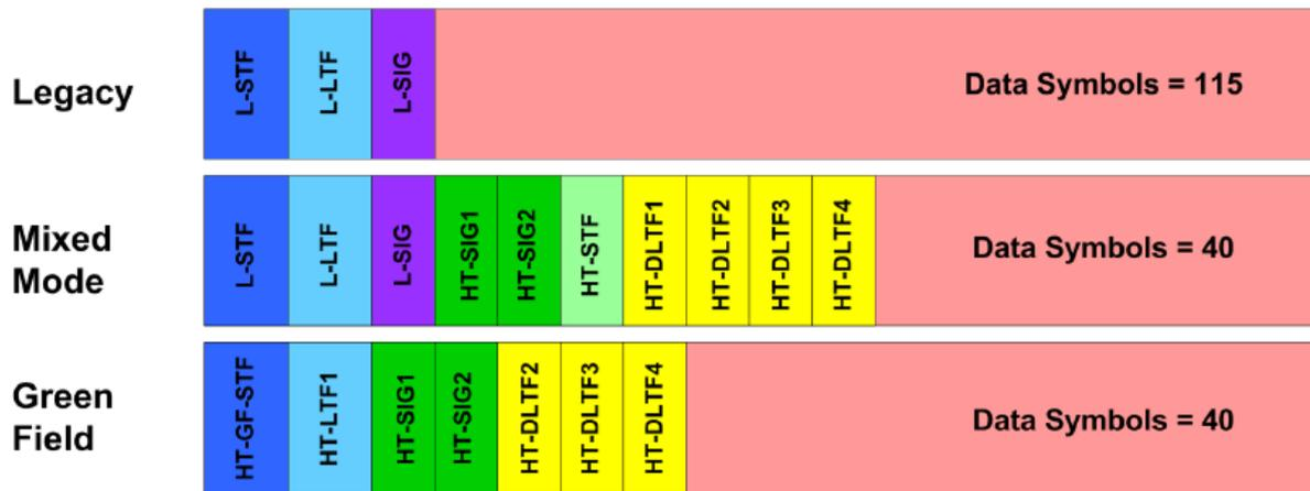
圖十:WLAN 802.11n封包格式示意圖
