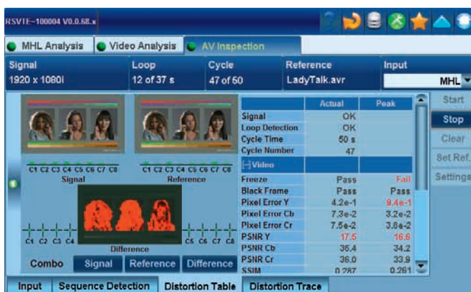
映像比較解析機能は、適切な評価方法を用いて、映像劣化の検出と解析を実施。
