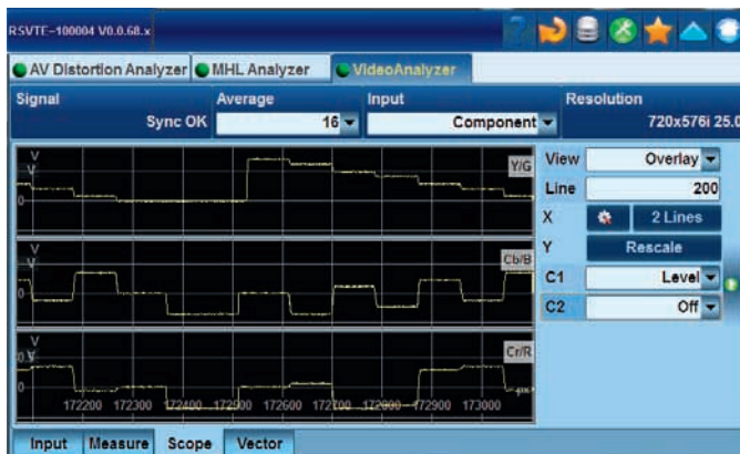
デジタル・コンポーネント信号のタイミングとレベルをタイムドメインで測定
