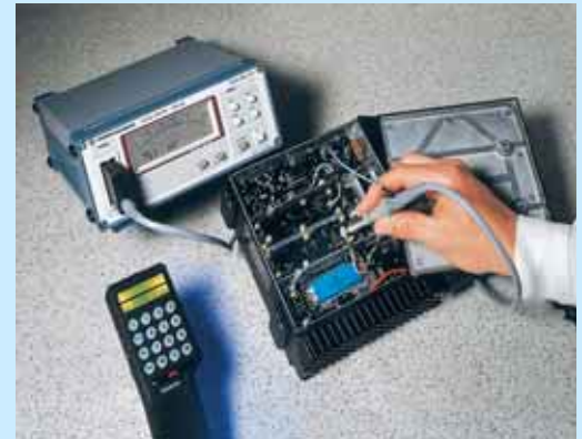
Belastungsarme Spannungsmessung mit HF-Tastkopf R&S®URV5-Z7
