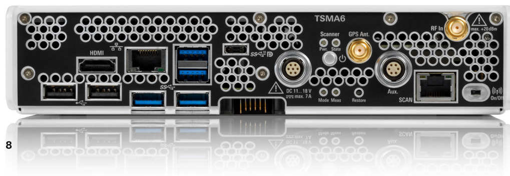
Face arrière du R&S®TSMA6 avec ses connecteurs.
