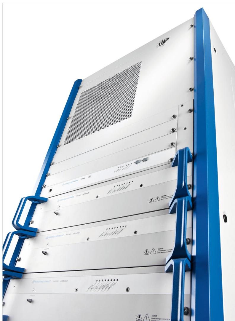
Die Integrationsvielfalt bei der R&S®THR9 Senderfamilie reicht vom Einzelsender mit integrierter Pumpeneinheit und Platz für weitere Systemkomponenten, über MultiTX-Mehrsendersysteme, bis hin zu N+1-Konfigurationen in einem Gestell.
