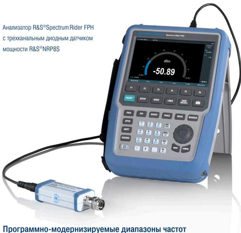
Анализатор R&S®Spectrum Rider FPH содержит широкий спектр стандартных функций, среди которых две спектральные кривые, демодуляция AM/ЧМ аудиосигналов, дистанционное управление и частотомер, которые используются при решении повседневных задач спектрального анализа. Инженеры по эксплуатации и сотрудники ремонтных лабораторий в различных отраслях промышленности смогут найти дополнительные измерительные приложения для повседневной работы, например, измерения пикового и среднего уровней мощности.
