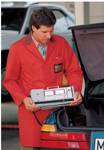
Bild 15: Leistungs- und Anpassungsmessung an einem Autotelefon für das D-Netz mit Durchgangsleistungsmesser NAS
