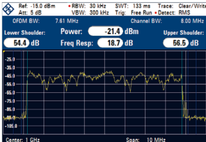
Typische Verzerrung des DVB-T-Spektrums durch das TU6-Fadingszenario.
