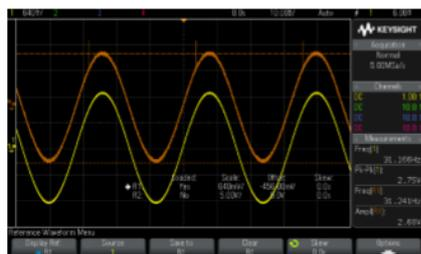
Keysight DSO/MSOX2000A: 8.5インチディスプレイ、800×480ピクセルの解像度
