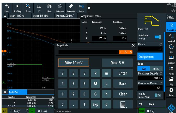
量測解析度可透過更改 the points / decade 加以調整
