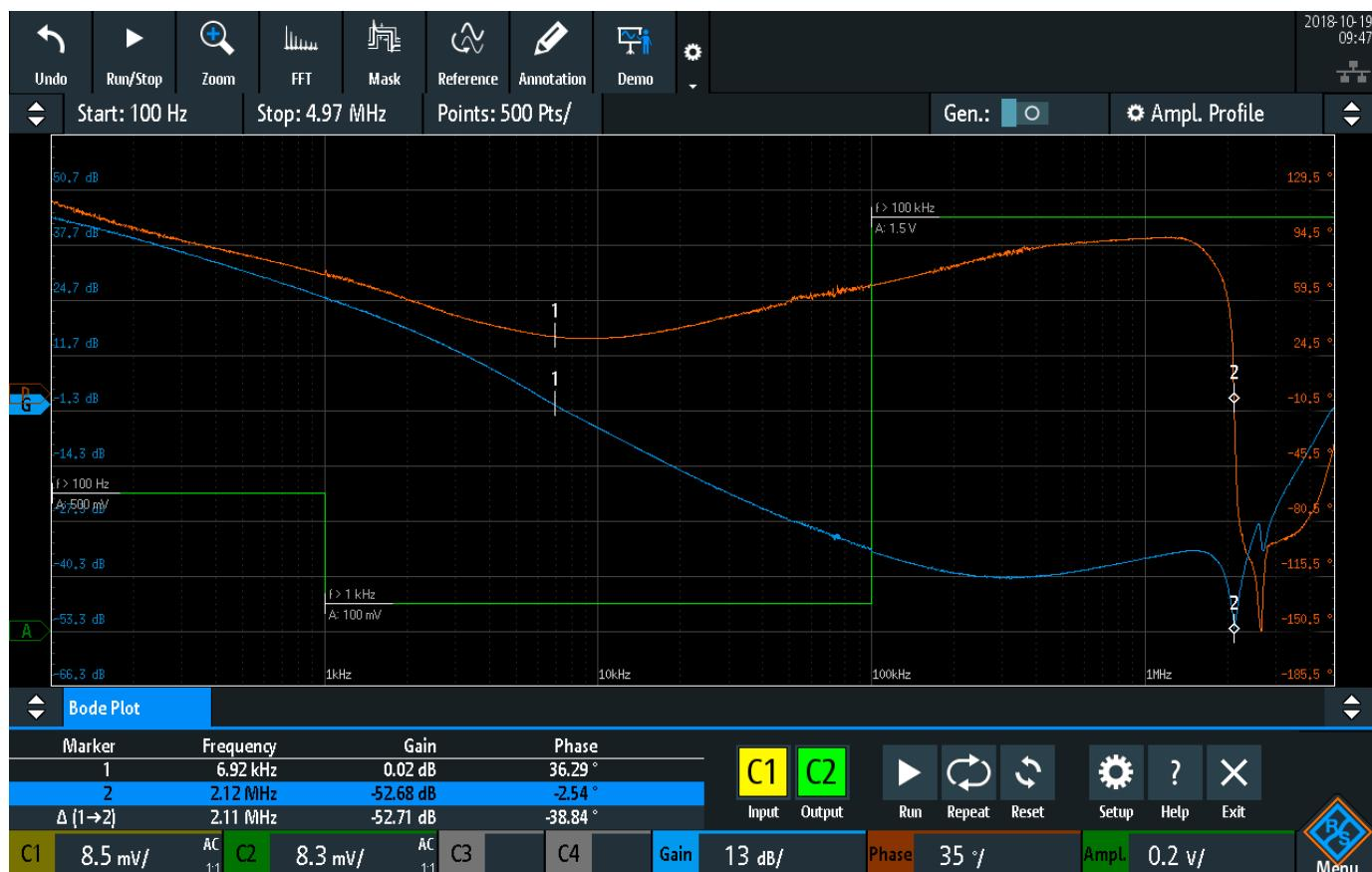
使用者可以在量測過程中改變產生器訊號的振幅輸出位準，以抑制 DUT 的雜訊特點
