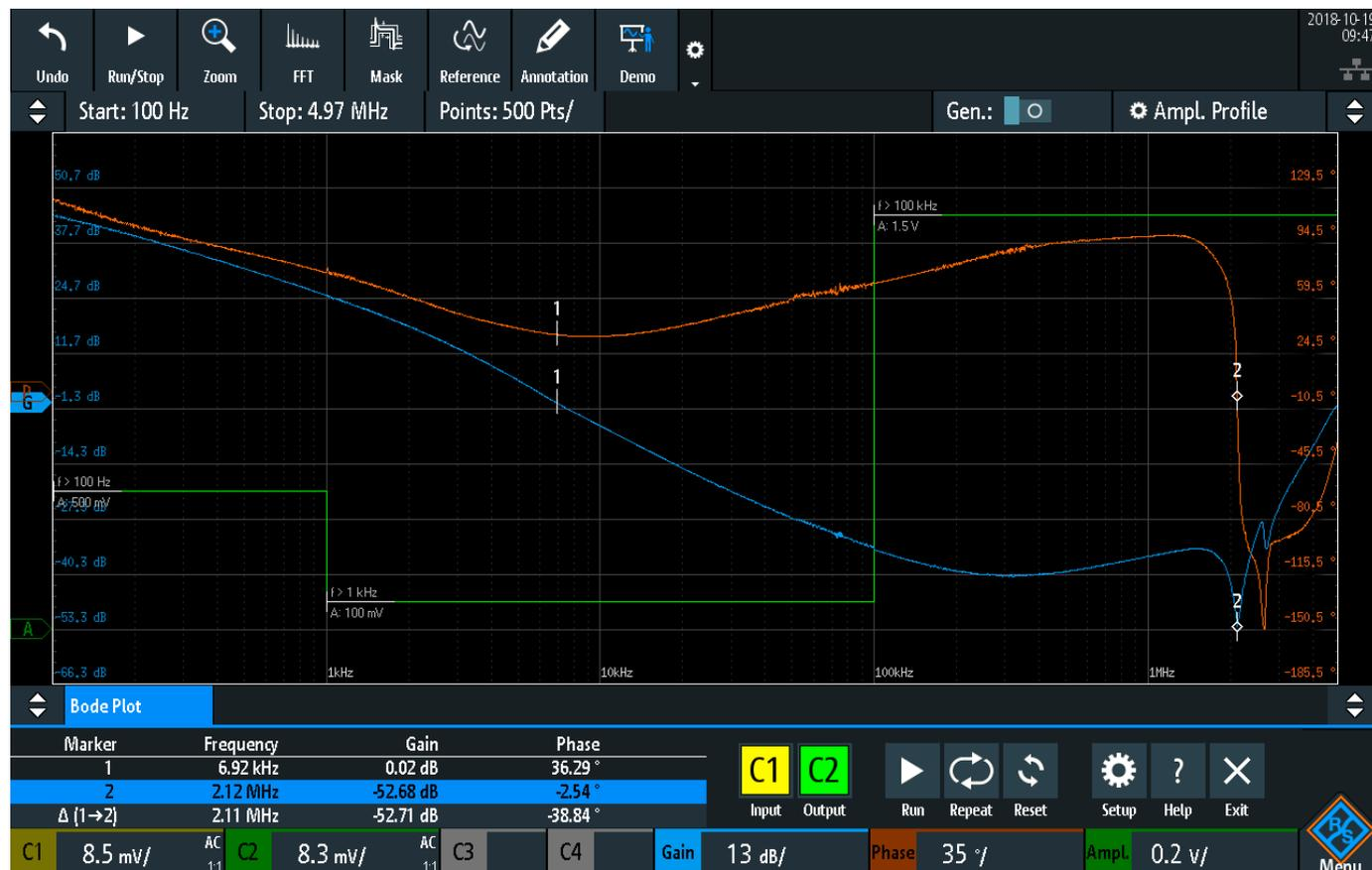
Pour éliminer le comportement parasite (bruit) du DUT, vous pouvez faire varier le niveau de sortie en amplitude du signal de générateur pendant la mesure.
