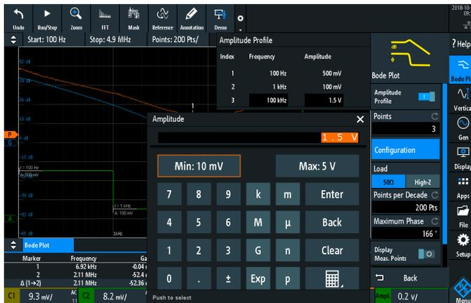
La resolución de la medición se puede variar cambiando los puntos por década.
