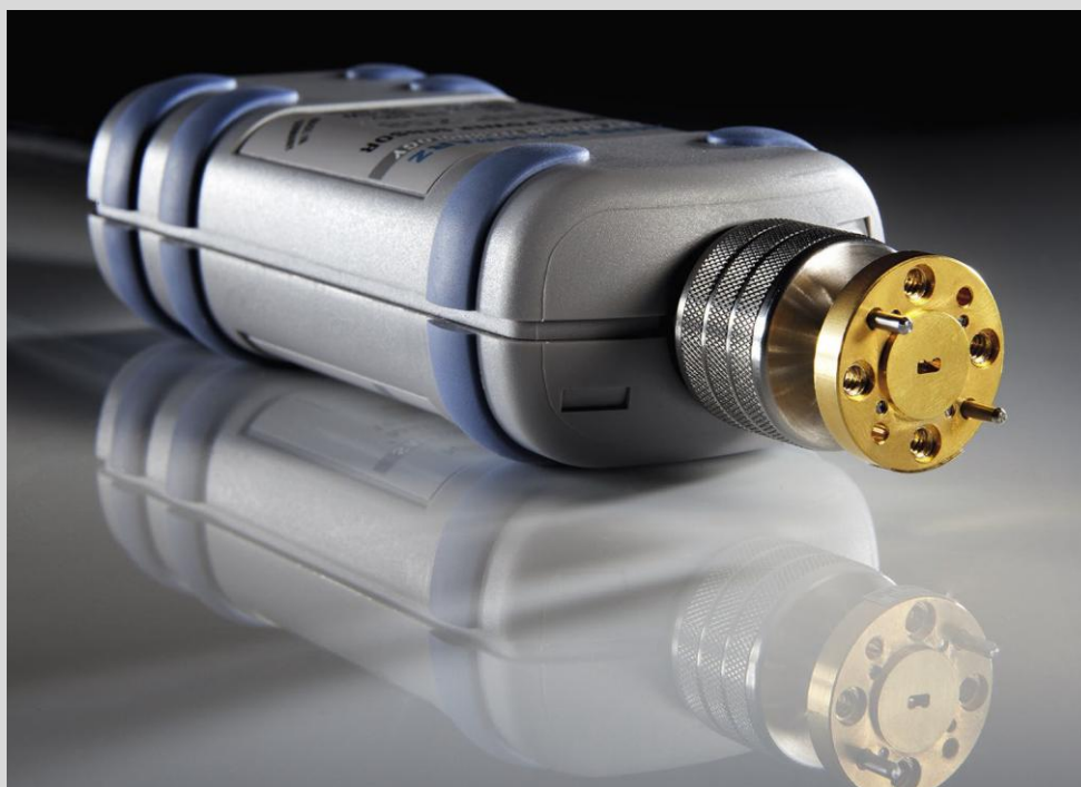
Рисунок 5 – Датчик мощности R&S®NRP-Z58 с волноводным адаптером для частотного диапазона WR-10 (R900, WG-27) от 75 до 110 ГГц.
