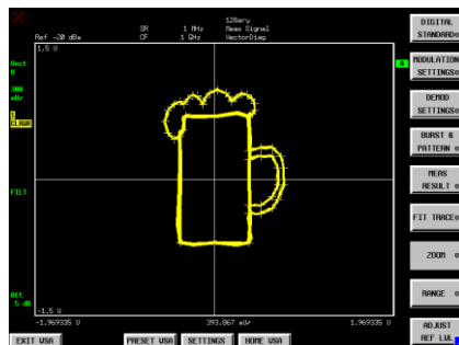
Рисунок 1-17 – I/Q-диаграмма сигнала, сформированного векторным генератором сигналов
