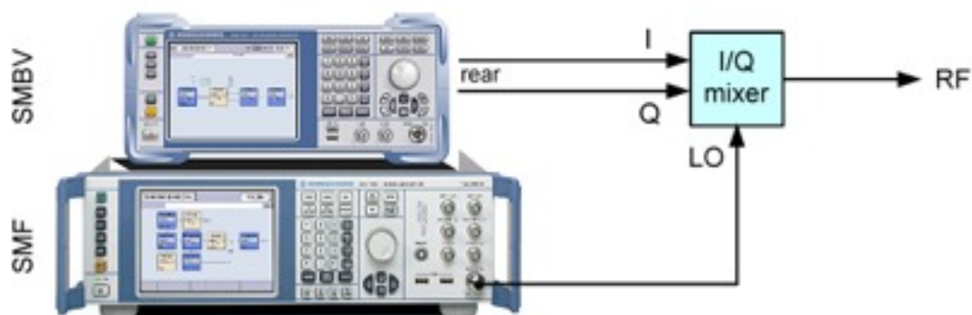
Рис. 15. Схема экспериментальной установки генерации векторных сигналов при помощи I/Q смесителя.
