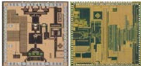
優れたフロントエンド性能を実現するために、各種テクノロジーをマルチチップ・モジュール上で組み合わせて使用しています。シグナルインテグリティと耐久性の両面で重要なコンポーネントである終端抵抗は、高い入力マッチングを実現するためにレーザートリミングで作られています。
