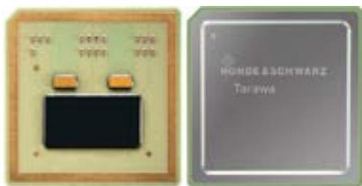
高速な波形更新レートと演算処理速度は、間欠的障害の迅速な検出をサポートし、大量な信号の処理動作中でも素早い応答性のある計測器を実現しました。高度に統合された内製の ASIC は、複数の並列プロセスを実行できるため、測定および演算時間を劇的に短縮します。
