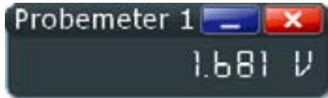
プローブメータによる DC 電圧モニタリング
