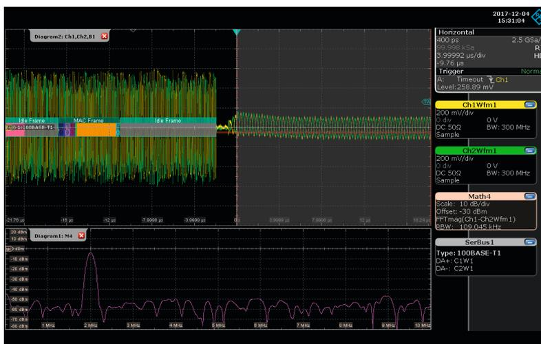
Analyse einer sporadischen Unterbrechung der Buskommunikation durch Kombination von Protokollanalyse und Frequenzanalyse.
