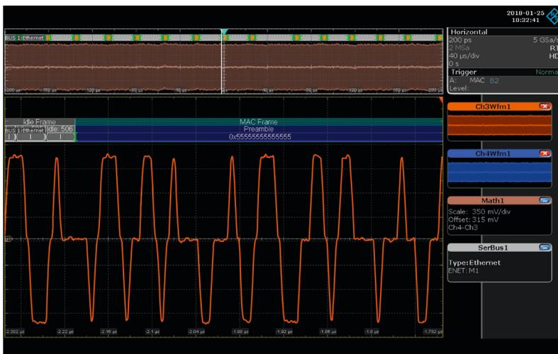
Differenzielles 100BASE-TX-Signal: Deutlich erkennbar sind die drei Level und die steilen Flanken im Übergang.
