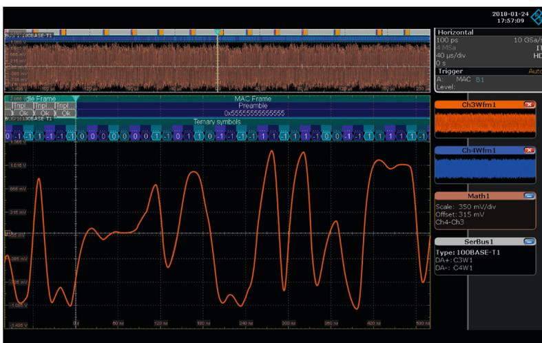
Automotive-100BASE-T1-Signal: Die drei Level des PAM-3-Signals sind durch die Vorverzerrung des Equalizers nicht immer deutlich erkennbar.
