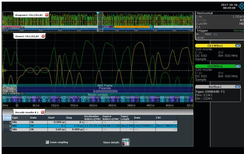
Decodierung der elektrischen 100BASE-T1-Buspegel. Deutlich sichtbar sind die zwei Pegel des differenziellen 100BASE-T1-Signals und der decodierte Telegramminhalt.
