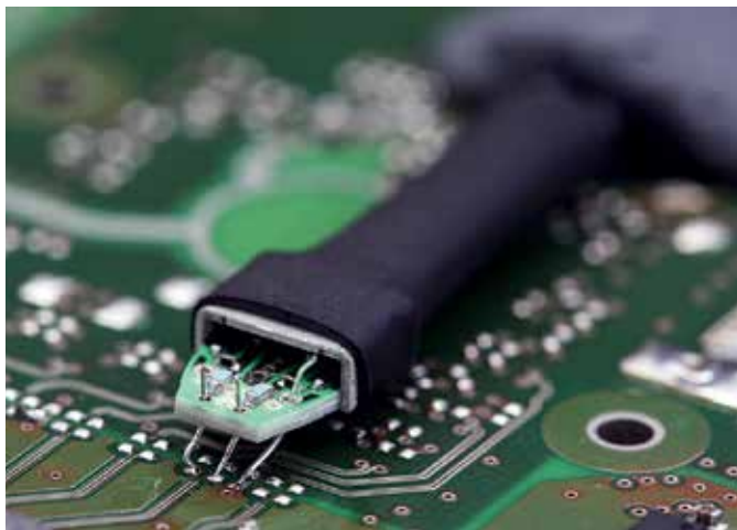
図7: R&S®RT-ZMA10 はんだ付けチップモジュールを使用した高速インタフェースへの接触
