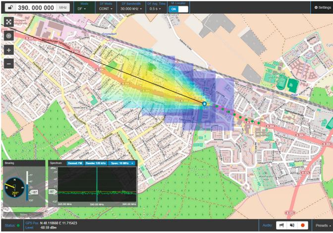
基于 PC 的 R&S®MobileLocator 自动无线电定位软件 ...
