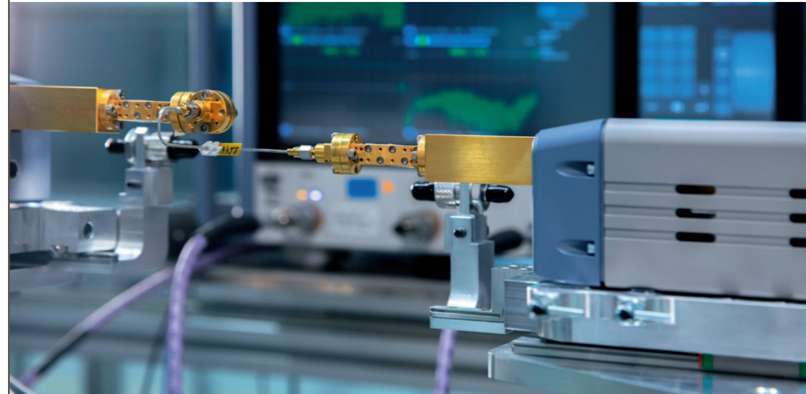
Testovací systém pro kabely (rozsah do 170GHz)
